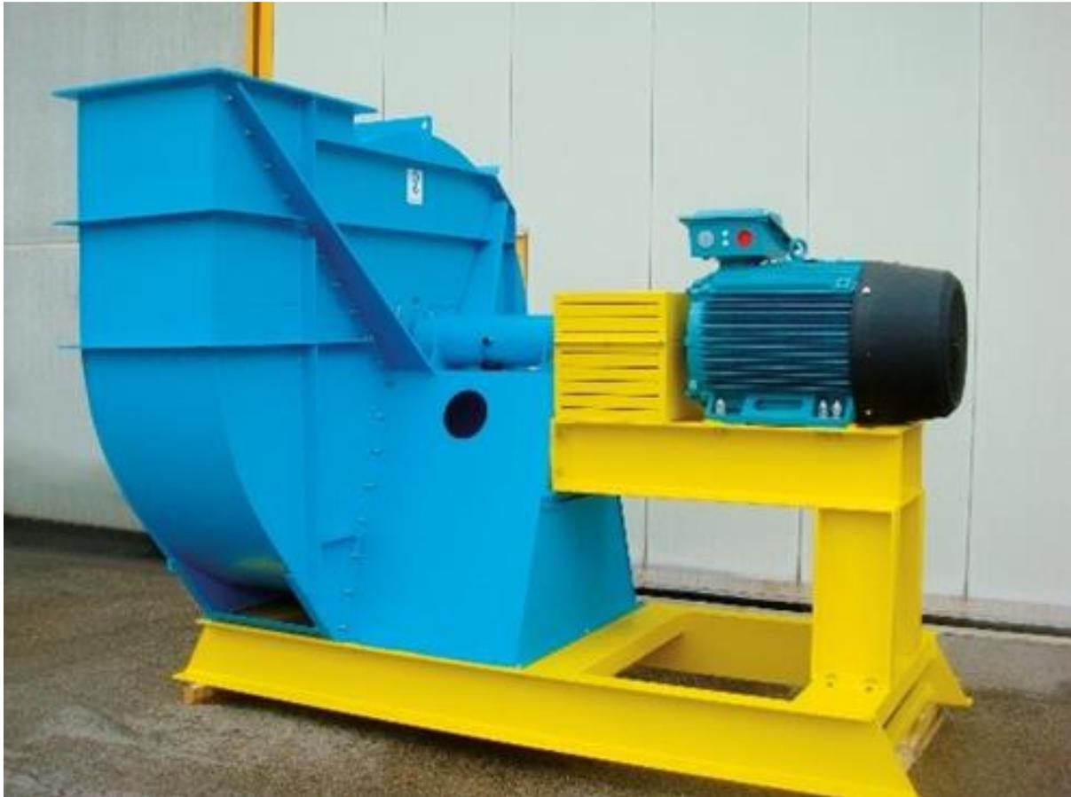
Particolare cura è stata posta alla scelta dell'unità moto-ventilante: in alternativa ai classici ventilatori con trasmissione del moto mediante cinghie e pulegge, si è optato per una trasmissione con giunto elastico abbinata a un motore elettrico con alta classe di efficienza.
